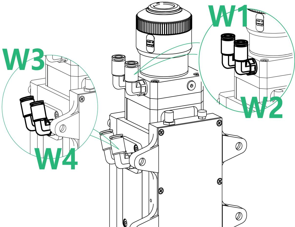
冷却水进出的方向可以参照图示进行连接。
