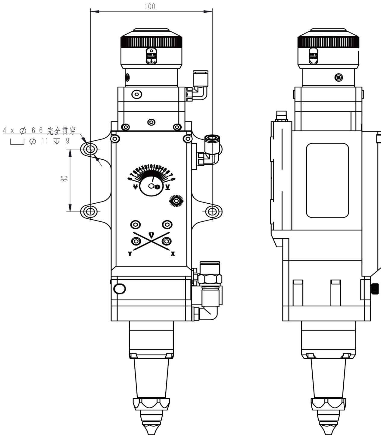
**i** 建议按照要求，将激光头垂直于加工面安装，并保证螺钉紧固，避免激光头振动。
