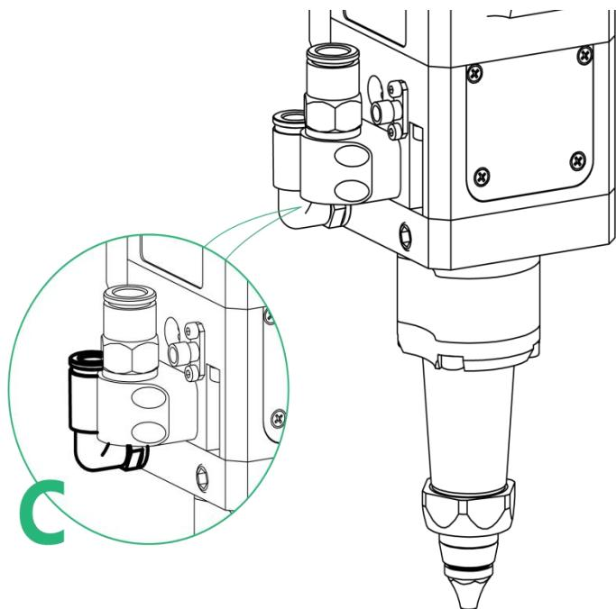
**!** 推荐使用干净且干燥的氮气或空气，不可使用氧气作为冷却气体
